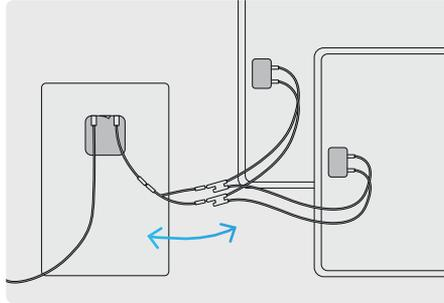
2. Speicher via Adapter mit Panelen verbinden
